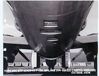
撮影のためF-13機体底面に設けられたガラス窓 米軍撮影 米国立空軍博物館所蔵
